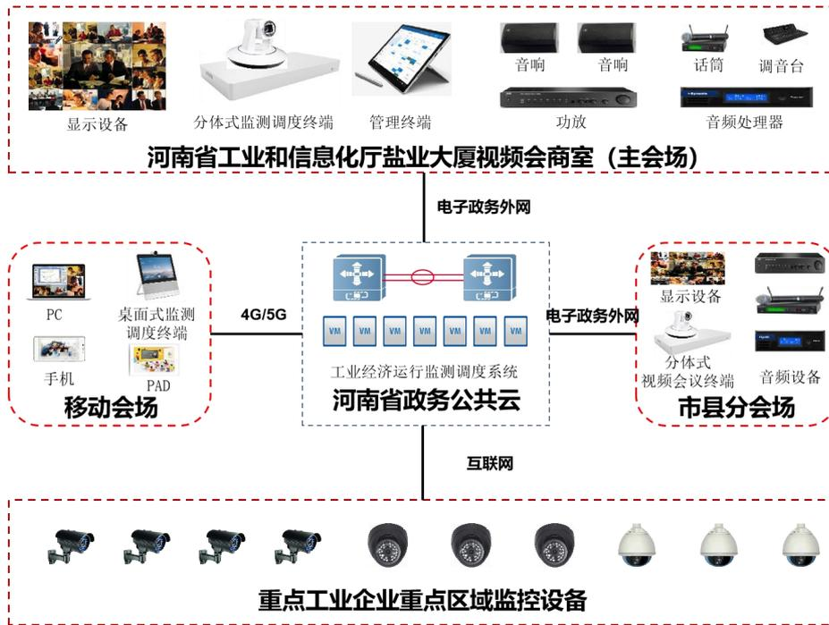
图1 监测调度系统架构
